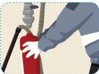
Bình chữa cháy chỉ dùng được 1 lần, dù không dùng hết thì bình cũng sẽ bị xì ra hết. Vì vậy, khi đã dùng xong hãy mang tới các cơ sở để nạp bình.
